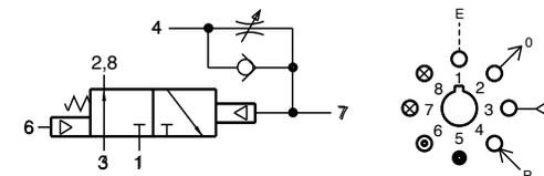
retrasará la activación de la válvula. La válvula de 3 vías con todas las vías y escapes roscados se puede usar normalmente abierta, normalmente cerrada, como selector o como divisor. El puerto 7 es auxiliar para agregar volumen para períodos de retraso más largos. Si no se usa, el puerto 7 se debe tapar.
